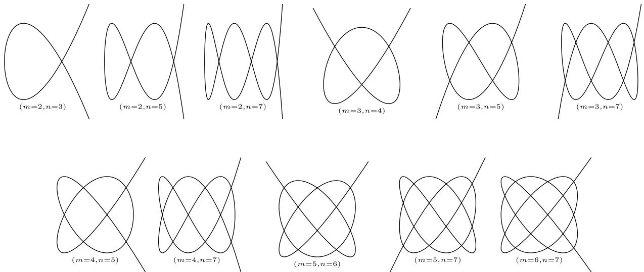
**4.16. QUADRILATERO ARTICOLATO E CURVE DI WATT.** Un quadrilatero articolato è un dispositivo formato da tre segmenti fissi incernierati ciascuno sul successivo, il primo e l'ultimo estremo in posizioni fisse sul piano. Scelto un punto  $P$  del segmento centrale, l'insieme delle posizioni che esso assume sotto i possibili movimenti del dispositivo è una curva del piano, detta curva di Watt. Eccone
